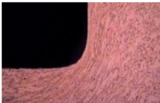
其他打薄方式改变了带材的内部结构，从而产生了不必要的内应力。
