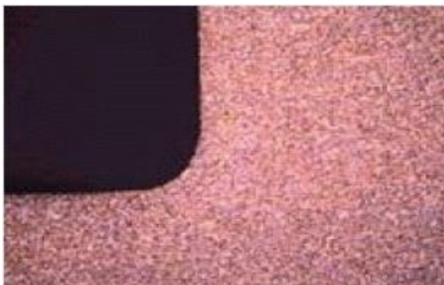
铣削产生的打薄通道，不额外产生内应力。
