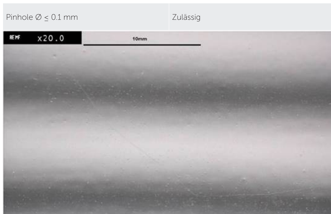
CuNiSi, C19010; 0,32 mm Materialdicke, 3–6µm Sn
