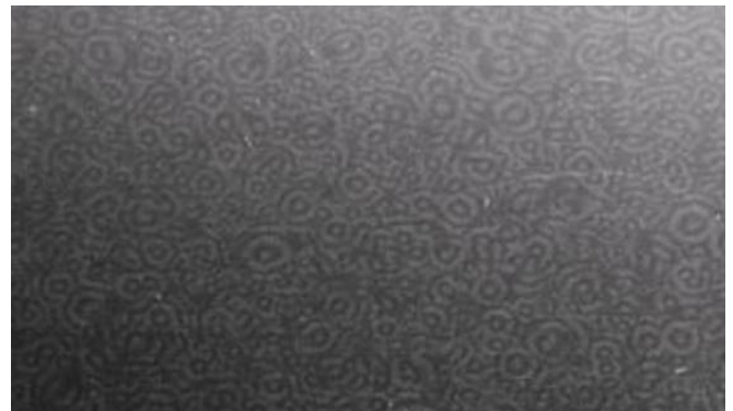
REM-Aufnahme der Oberfläche einer SnTEM-Beschichtung
