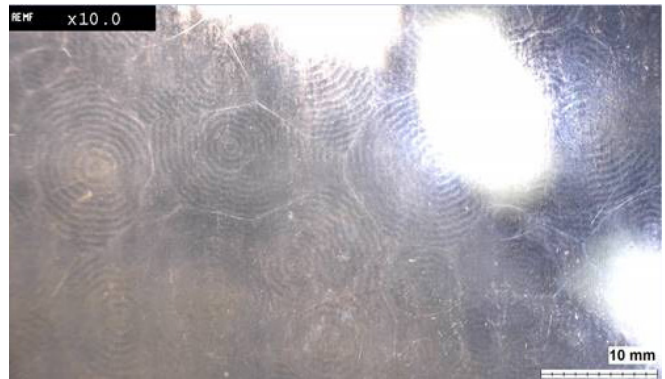
Dickverzinnung mit typischer Kreisstruktur
