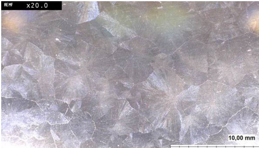
K81; 0,2mm; 1–3 \mu m Zinnschichtdicke; SnTOP
