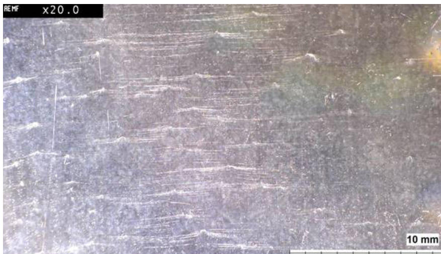
Beispiel: B14; 0,315mm; 1–3 \mu m Zinnschichtdicke; SnPUR (Abblasrichtung vertikal)
