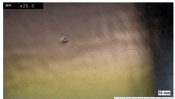
Einzel auftretende Vertiefung als Folge einer Entnetzung
