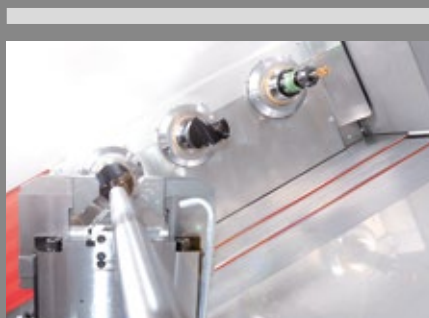
Automatisierte Werkzeugmaschine zur Endenbearbeitung von Lenkzahnstangen.
