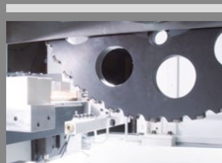
Bearbeitungszentrum zur Komplettbearbeitung von Hochspannungskontakten aus Profilstangen.
