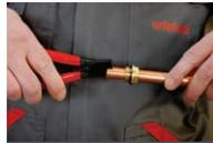
Markierzange mit der Noppe komplett in das Rohr einschieben und die Anschlagpunkte auf das Rohr drücken.
